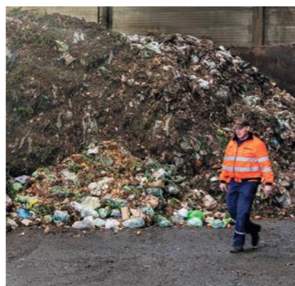
Bevor der Biomüll der Biogasanlage zugeführt werden kann, müssen Plastik und organische Bestandteile voneinander getrennt werden.
